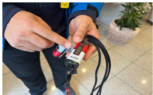
รูปที่ 22 GPS สำหรับใช้วัดความเร็วในการเคลื่อนไหว
